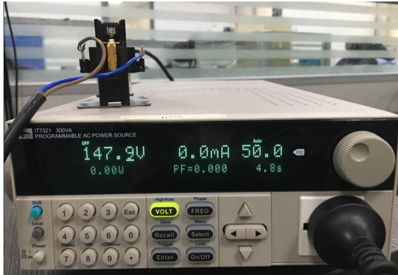
图一、IT7300 交流源测试交流接触器实例
