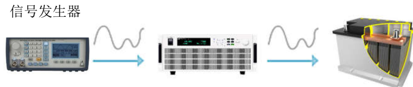
图一、信号发生器通过模拟量控制 IT8900A 负载拉载任意波形
