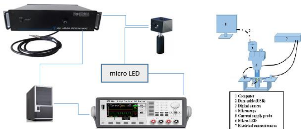
Micro-LED阵列亮度测量示意图
